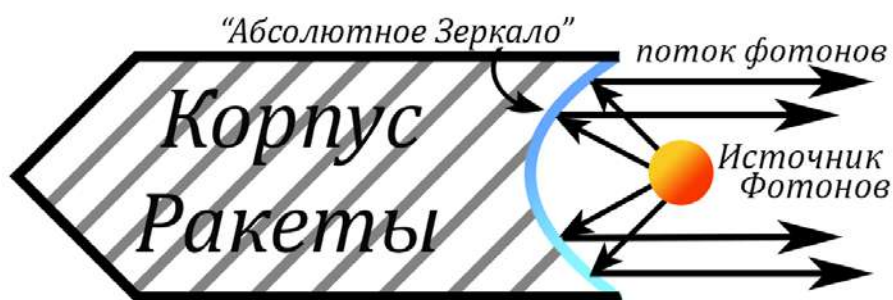
Рис. 2. Схема фотонного двигателя
