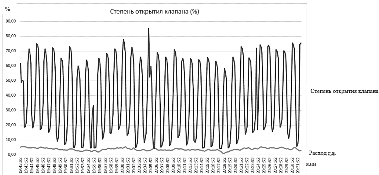
Рис. 4. График изменения степени открытия клапана, регулирующего подачу греющей воды в теплообменник
