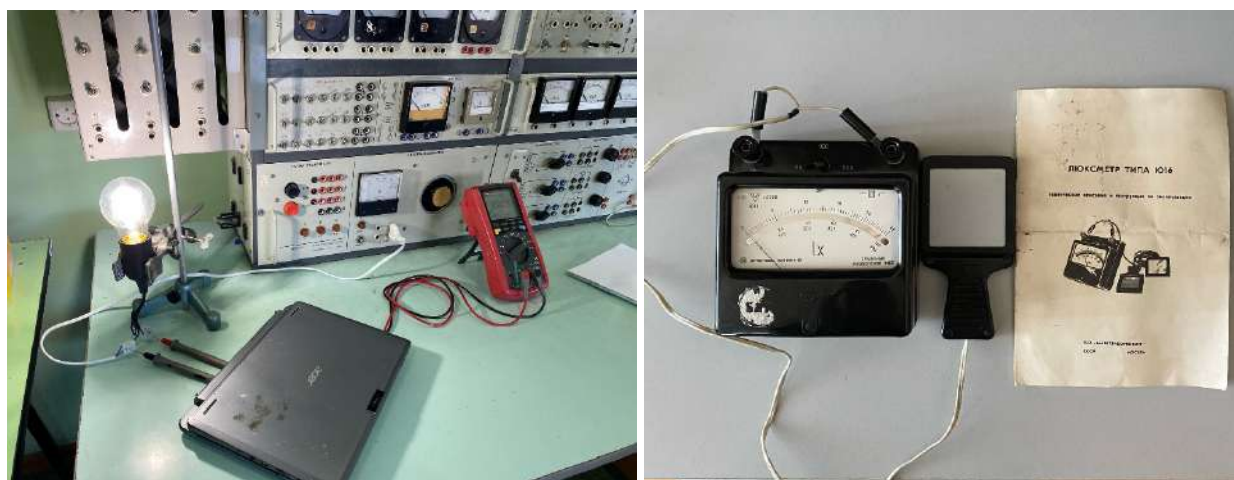
Рис. 1. Установка для исследования характеристик светодиодной лампы
