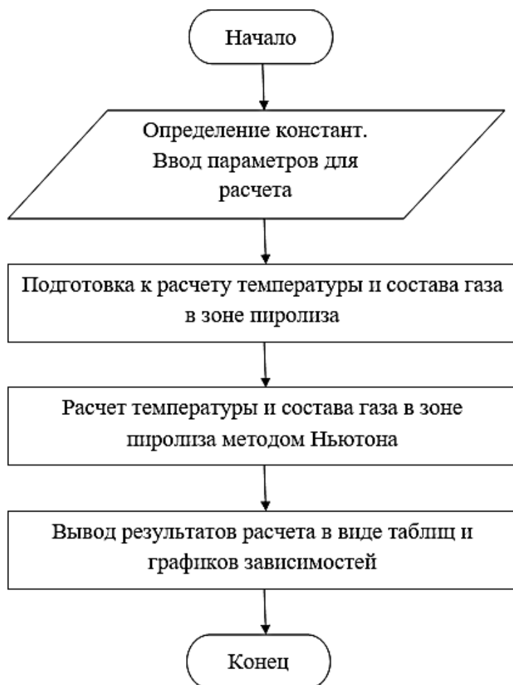
Рис. 1. Алгоритм моделирования зоны пиролиза
