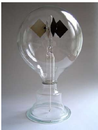
Рис. 1. Радиометр У. Крукса
