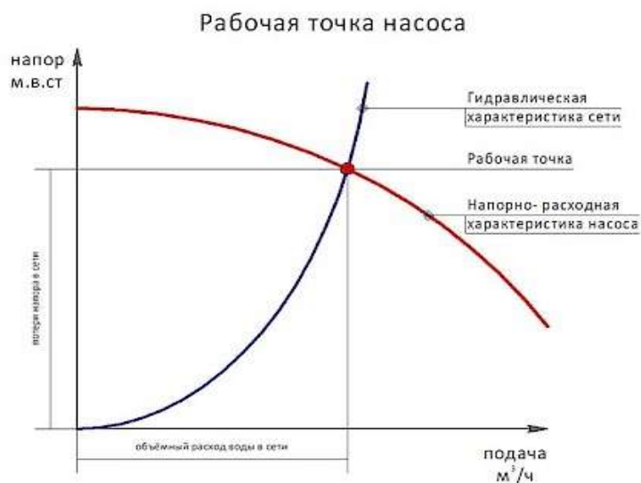
Рис. 2. График характеристик сети и насосного агрегата
