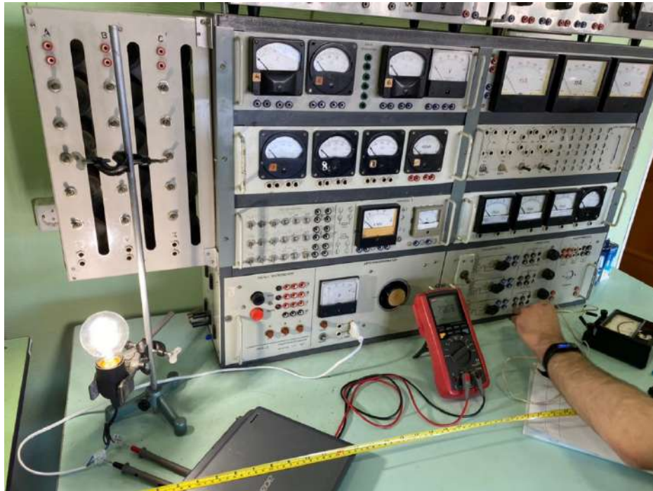
Рис. 1. Установка для исследования характеристик светодиодной лампы
