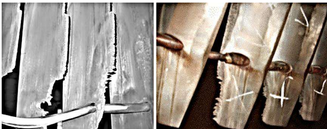
Рис. 3 - Эрозионное разрушение лопаток турбины К-1200-240
