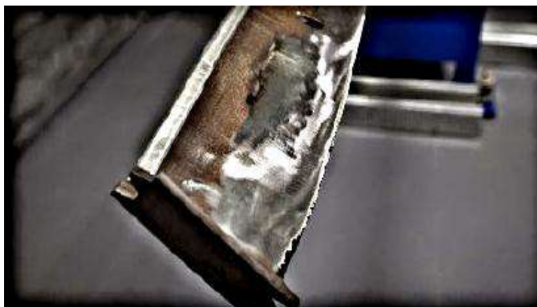
Рис. 2 - Поврежденные лопатки турбины К-1200-240
