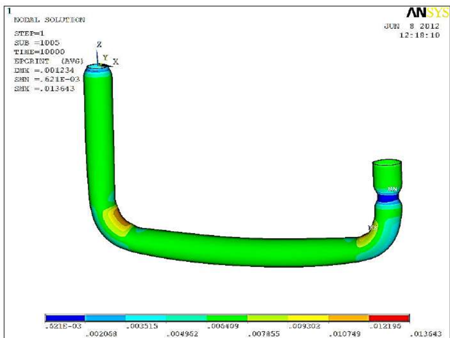
Рисунок 4. Изолинии интенсивности деформации ползучести для 10 тыс. часов
