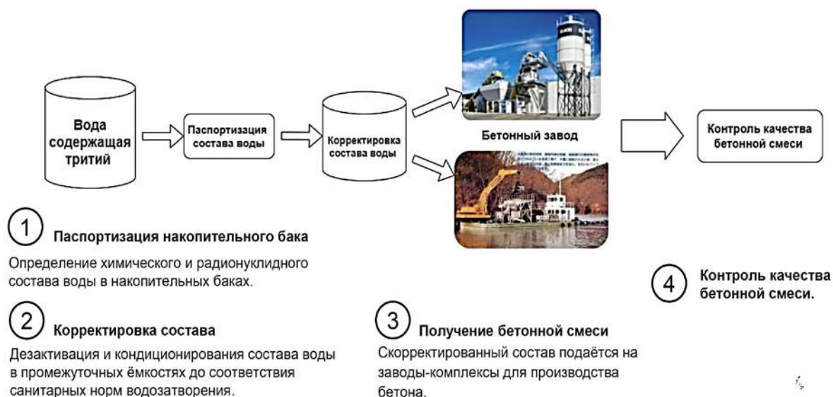
Рисунок 3. Схема использования загрязненной воды для производства бетонных смесей
