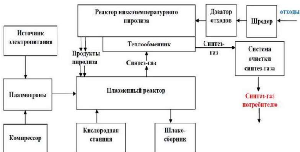
Рисунок 3. Схема для переработки мусорных отходов комбинированным путём
