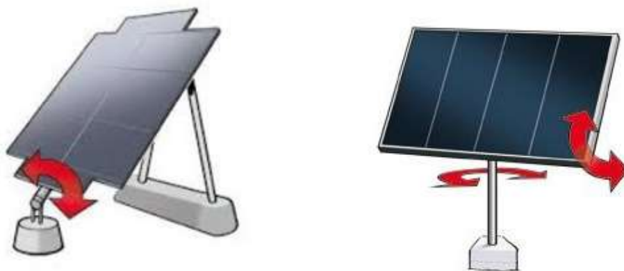
Рисунок 1. Одноосевые и двухосевые системы трекинга (соответственно)
