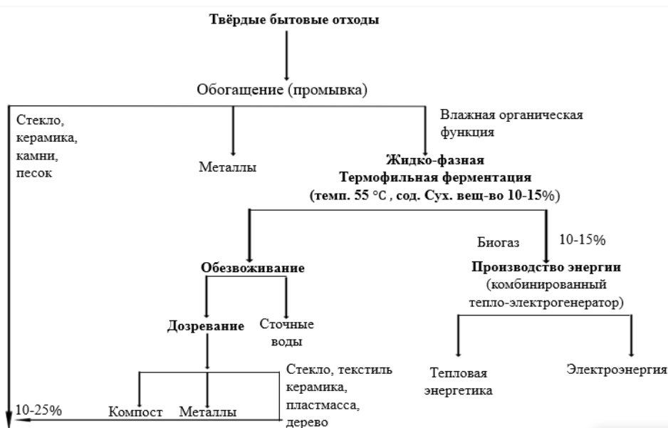
Рисунок 4. Схема переработки ТБО с включением анаэробной ферментации
