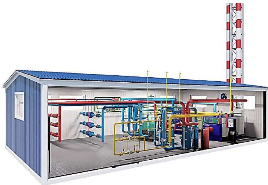
Рисунок 2. Состав блочно-модульной котельной
