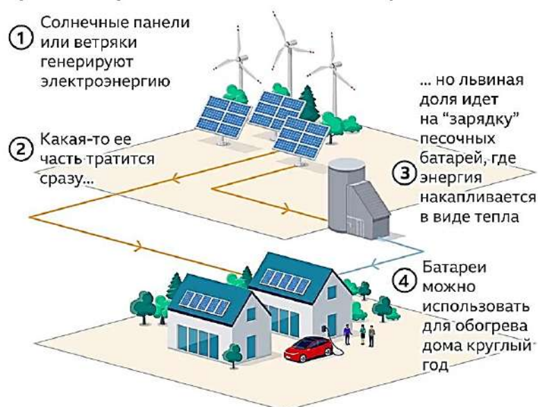
Рисунок 2. Принцип работы песочных батарей
