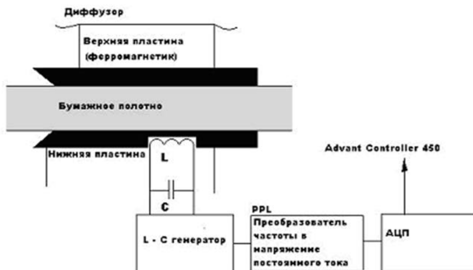
Рисунок 5 – Схема работы датчика толщины
