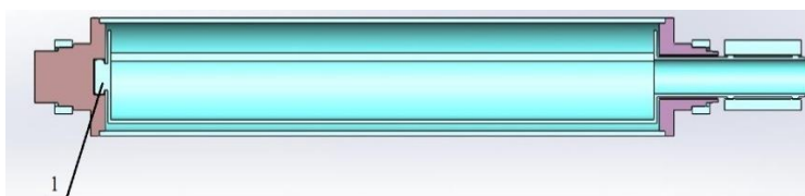
Рис. 17 Модель поворотного вала в программе Solid Works. 1 – сферическая цапфа.
