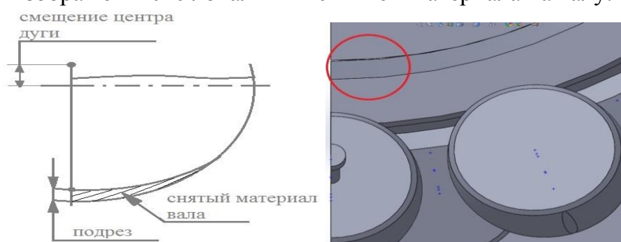
Рис. 19. Подшипниковый узел с локальным снятием металла на валу.
